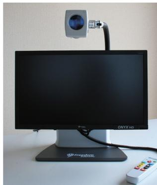
20インチモニターの上にあるHDカメラで対象物を映し、拡大する。拡大縮小や色の切り替えなどの操作はリモコンで行う。カメラの向きを変え、遠方やご自身の顔を映すことができる。設定によりライン、マスキングも可能。
