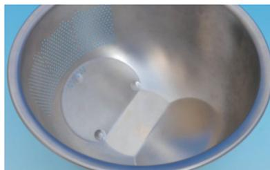
側面の一部にザルのような網目があることで、ボウルとザルの機能が合わさっている。ボウルの底が3面になっているので、網目を下にして傾けると「水切り」ができ、反対側に傾けると「洗う」「和える」ことができ、水平状態にすると「さらす」ことができる。
