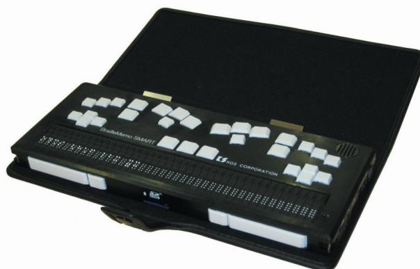
Bluetooth機能を搭載、点字プリンターへの出力が可能。点字ディスプレイは40マスなので、点字文書の校正に適している。
