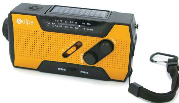
防災グッズとして最適なLEDライト付き小型ラジオ。手回し、ソーラー、USB充電ができ、乾電池でも使用できる。携帯電話やスマートホンへの手回し充電も可能。
