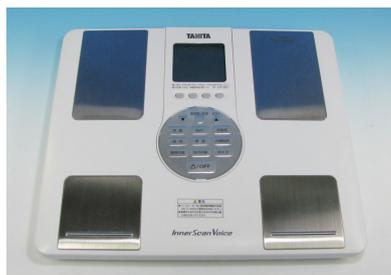
計測は体重、体脂肪率、BMI (体格指数)、筋肉量、内臓脂肪レベル、基礎代謝量、推定骨量、体内年齢、体水分率の9項目。
