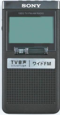
ワンセグTV音声/FM(ワイドFM)/AMラジオが入手のひらサイズのポケットラジオ。お住まいの地域を選ぶと自動的にその地域で放送されている局がセットされ、ジョグダイヤルで簡単に選局ができる。天面にある10個のダイレクトボタンにも登録されるのでボタンで選局できる。
