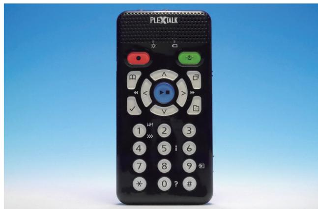
SDカードを使った小型軽量のデジター録音再生機。デジター図書や音楽を再生するほか、テキストやワード文書を音声で読み上げる。デジター形式で長時間録音できるので、ICレコーダーとしても使える。PTR3とつないでデジター図書をSDカードにバックアップできる。
