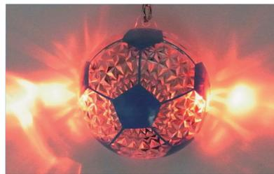
半球の形をしたキーホルダーで、揺れると暗さと振動を感知し赤色LEDが発光。また本体の反射材がピカッと反射し夜間の交通事故防止に役立つ。太陽光などで充電できるソーラーパネルを使用し、電池交換不要。\*防水ではありません。
