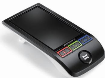
5インチ液晶画面の携帯型拡大読書器。大きな3つのボタンを押すだけの簡単操作で、カメラが真ん中についているので拡大像に違和感がない。書き込み作業がしやすい設計。
