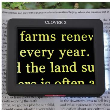
3.5インチ液晶。ポケットサイズで重さはわずか約100g。バッテリーの連続稼働時間は約3時間で、外出先で便利に使える。
